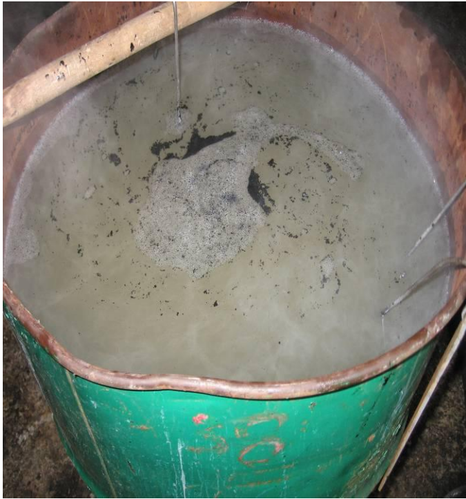
Фрагмент мойки пластины с нанесенным битумом, методом «погружения».
